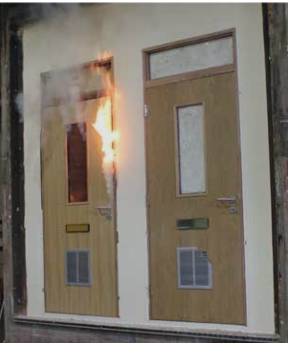
Fire door test
